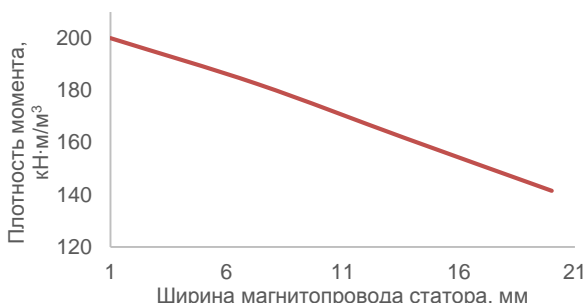
Рис. 8. Зависимость электромагнитного момента модулятора от ширины магнитопровода статора
