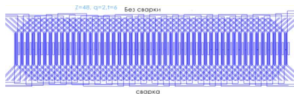
Рис. 5. Чертеж обмотки электромотора Xiaomi V6s
