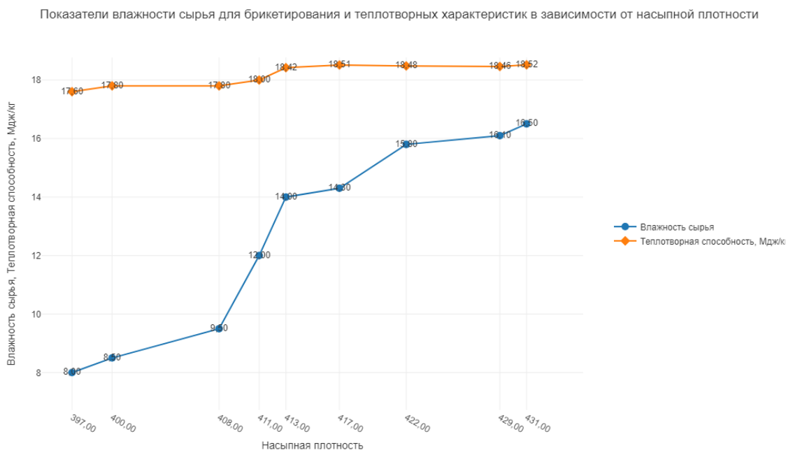
Рис. 5. Показатели влажности сырья для брикетирования и теплотворных характеристик в зависимости от насыпной плотности
