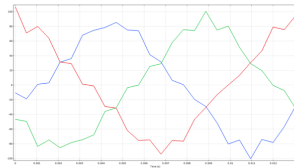
Рис. 10. Распределение ЭДС в генераторном режиме при частоте вращения 77 Гц
