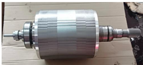
Рис. 3. Ротор электродвигателя Xiaomi V6s
