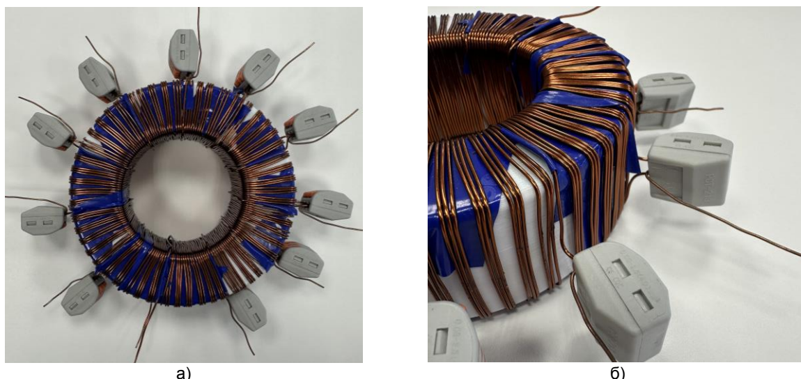
Рис. 4. Тороидальная катушка для проведения испытаний по измерению индуктивности
